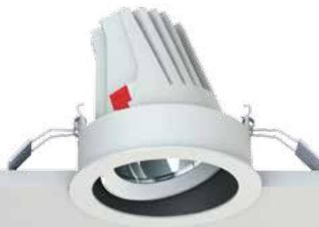
Der verstellbare Teil des Einsatzes ist in geneigter Position dezent in der Decke integriert. Dadurch wird ein höherer visueller Komfort mit besserer Entblendung erzielt. Bis zu 355° Drehung und 30° Neigung sind möglich. COMFORT ist in den Größen M und L verfügbar. In M liegt der Spot um 30 mm, in L um 48 mm rückversetzt.
